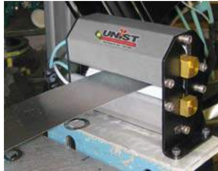
鋁板 - 滾輪微量薄膜潤滑
