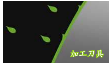
借由MQL將Coolube潤滑油薄膜完美的送到刀具表面
