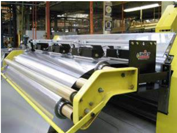
飲料、汽水鋁罐抽取設備 - 滾輪微量潤滑
