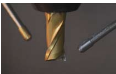
在銑削多軸加工最好是安裝MQL雙噴嘴潤滑
