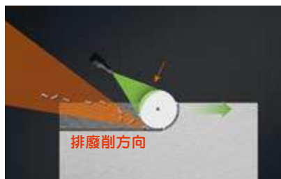
噴灑潤滑油在不受排廢碎屑干擾才能順利送入刀具和工件表面
