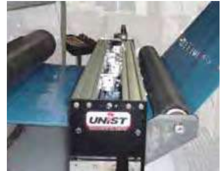
不銹鋼板 - 滾輪微量薄膜潤滑
