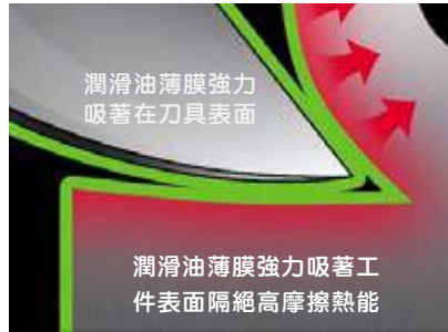
薄膜非常有效的減少摩擦力 和因摩擦力所產生的熱能
